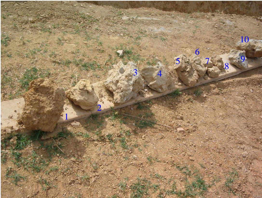
Foto n°1: Sondaggio. Zolle n°1-10 (profondità 0,25-16,5 m).
