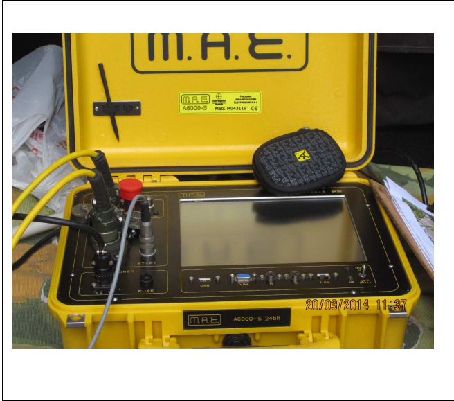
Particolare strumentazione Sismografo A6000S della Mae srl a 24 canali e 24 bit
