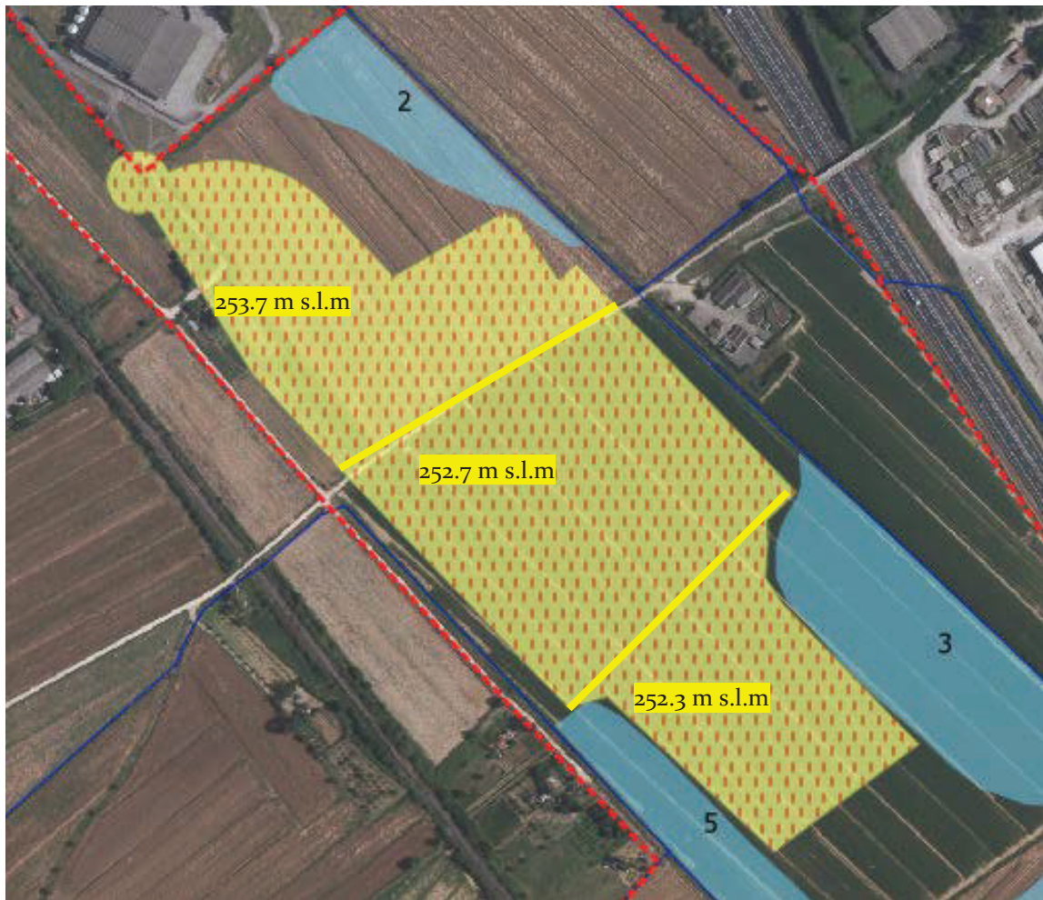
Fig. 8.27 – indicazione delle quote assolute dei piani id imposti per l'area in cui sono previste le opere di urbanizzazione, il valore della quota è comprensivo di 0.3 m di franco di sicurezza. Il battente medio nelle aree intorno al rilevato è di circa 40 cm.
