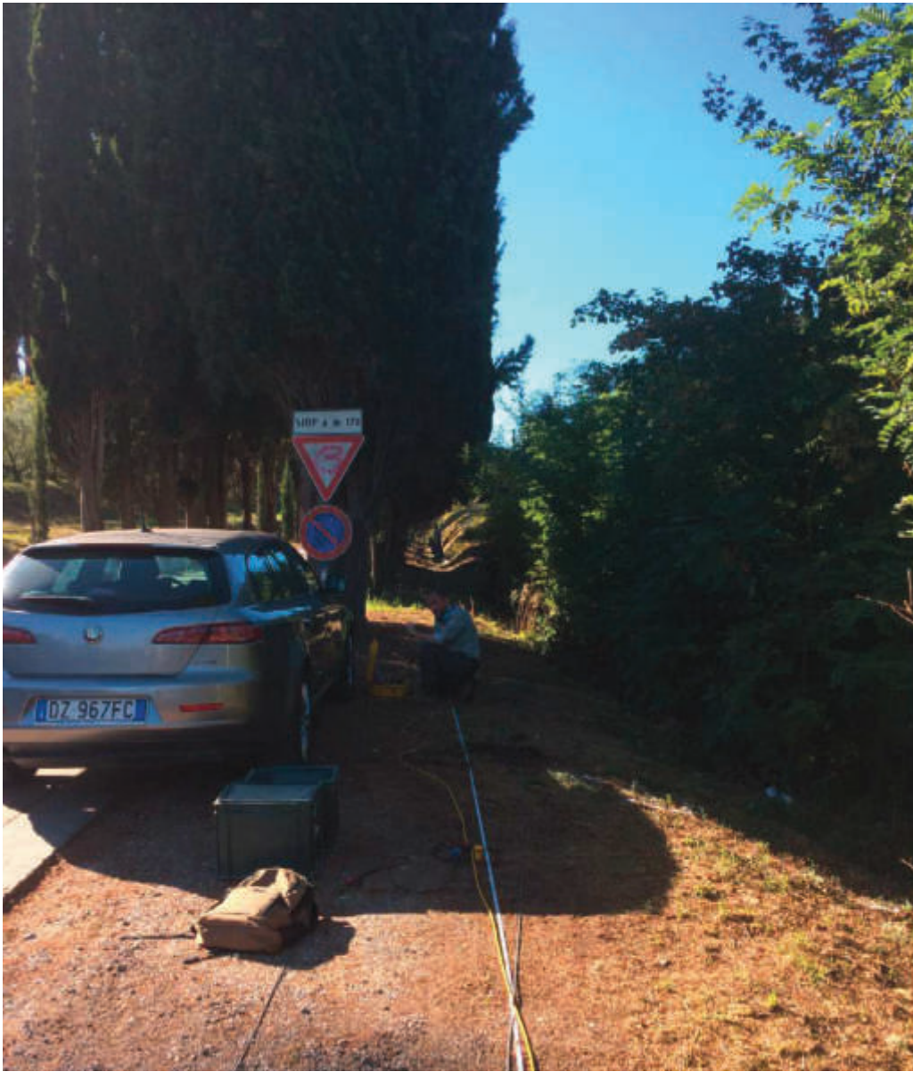
Profilo sismico 1 - Prospezione sismica onde P e SH – fase di esecuzione Zona S. Biagio – Viale della Rimembranza - Montepulciano (SI)
