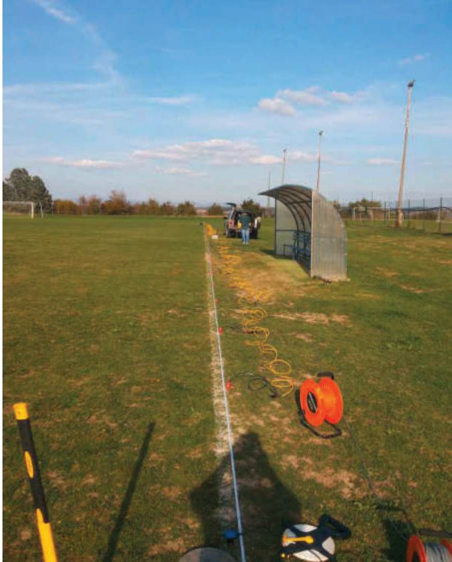
Prospezione sismica M.A.S.W. – fase di esecuzione
